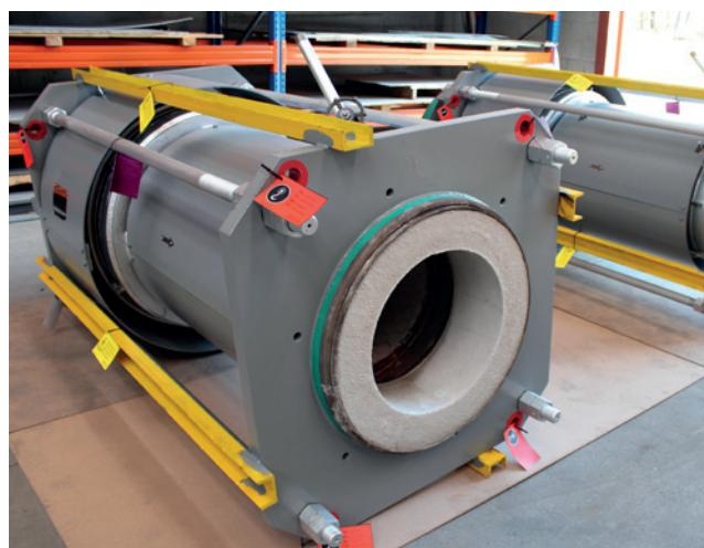
Материалом сильфонов для большинства применений в FCCU является Inconel 625LCF. Сплав INCONEL® 625LCF (UNS No6626 / W. Nr. 2.4856) разрабатывается как улучшенная версия с сопротивлением усталости сплава INCONEL 625. В соответствии с большинством спецификаций требуется, чтобы материалы сильфонов были подвергнуты отжигу, либо отожжены на твердый раствор после образования.
